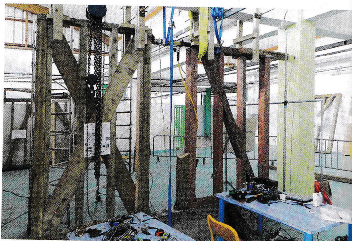
Un panneau de stabilité avec deux diagonales de petite section (à g.) est soumis à un chargement par palier contre un mur de réaction en bois de courbaril (à dr.).
