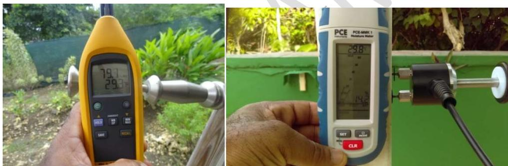
**Figure 11 : Hygromètre renseignant l'humidité relative et la température de l'air**
