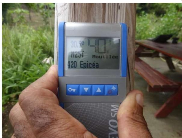
**Figure 8 : Mesure d'humidité du bois à l'aide d'un humidimètre capacitif**
